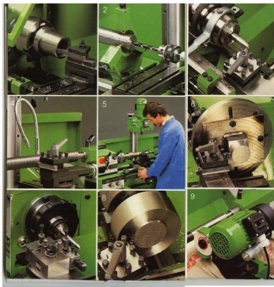
Gambar 1.17. Beberapa contoh proses bubut dengan cara pencekaman/pemegangan benda kerja yang berbeda-beda.
